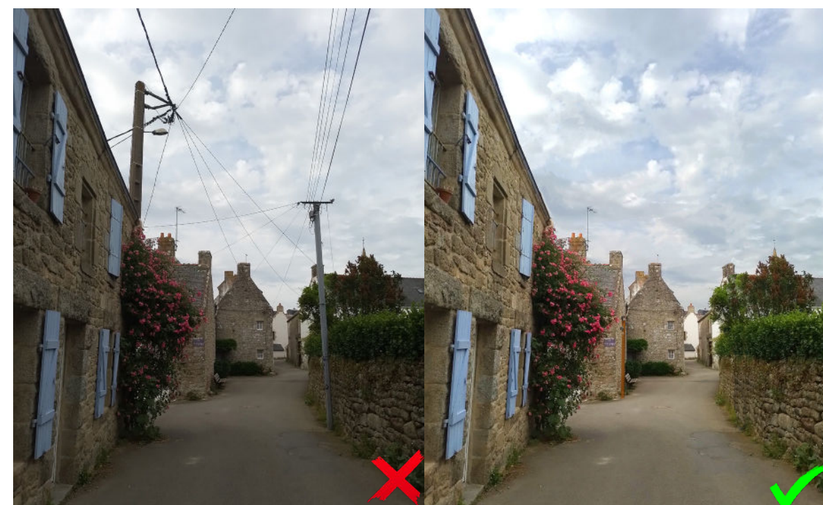
L'enfouissement des réseaux aériens et l'effacement des poteaux permettent déjà de restaurer le caractère pittoresque du village. Les luminaires peuvent alors être remplacés par des candélabres plus modernes et intégrés.
